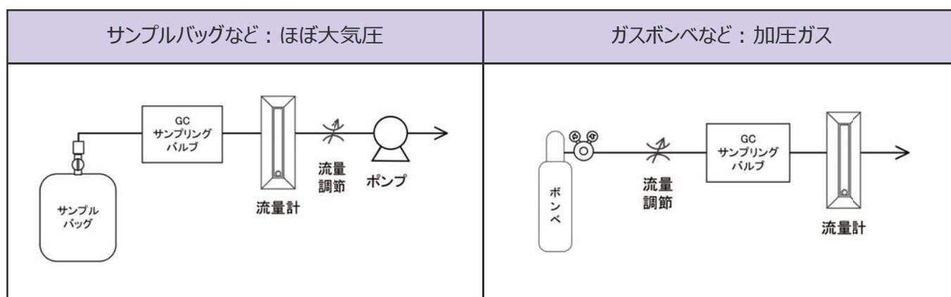
通常、流量調整用のニードルバルブは、サンプルバッグの場合は下流側(ポンプ側)に、ボンベガスの場合は上流側に配置されます
